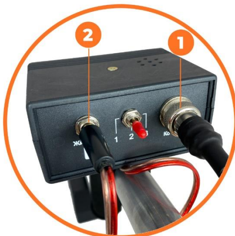
Малюнок №9 – З'єднання нижньої штанги з пошуковою катушкою
