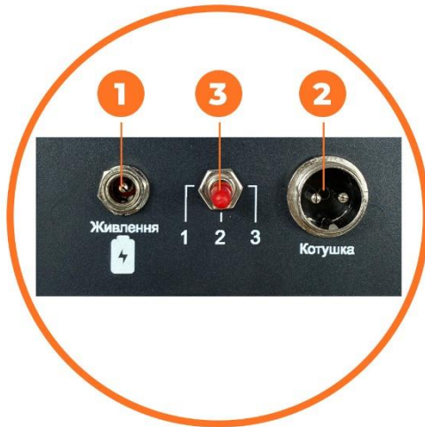
Малюнок №6 – Задня панель блоку управління ImPULS
